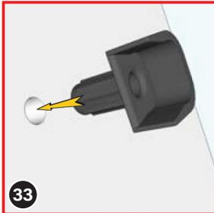
Insérez ensuite les douilles des axes de fixation (15) dans les quatre trous, avec le côté ouvert orienté vers l'intérieur, c'est-à-dire en direction de la pièce.
