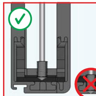
17 Vissez la vis de pression (10) dans le socle uniquement jusqu'à la profondeur indiquée sur l'image ci-dessus.
