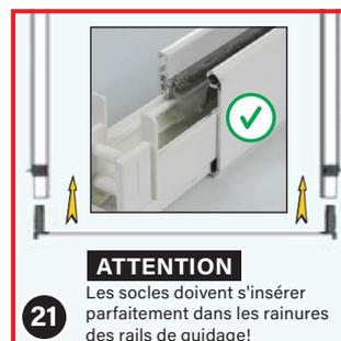
21 **ATTENTION** Les socles doivent s'insérer parfaitement dans les rainures des rails de guidage!
