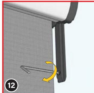
12 Les deux têtes (2) possèdent une languette avec un trou. Vissez maintenant une vis de pression (10) dans ce trou depuis l'intérieur, en utilisant la clé hexagonale (9) fournie.
