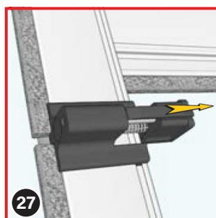
Vous pouvez également verrouiller le mécanisme des axes de fixation (15) pour installer ou retirer le store. Cela facilite la manipulation et protège vos murs. Pour ce faire, tirez simplement sur l'axe de fixation.
