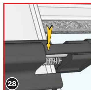
Appuyez maintenant sur la petite languette de l'axe lorsqu'il est en position ouverte. Cela ne revient pas immédiatement en place.
