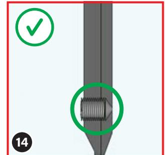
14 Vissez seulement jusqu'à ce que la pointe de la vis de pression (10) soit alignée avec l'autre côté de la languette de la tête.
