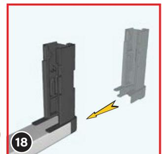
18 Ensuite, insérez les socles (6) sur les côtés du profil de finition. Si cela est un peu difficile, vous pouvez tapoter doucement avec un marteau (en caoutchouc) pour faciliter l'ajustement.
