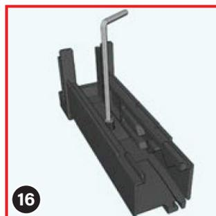
16 Vissez maintenant une vis de pression (10) dans le trou de chaque socle à l'aide de la clé hexagonale (9) fournie.
