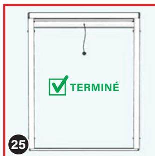
Le caisson supérieur du store, les rails de guidage latéraux et le profil de finition inférieur forment désormais un cadre assemblé.
