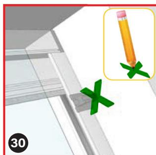
Marquez ensuite la position des axes de fixation (15) à l'aide d'un marqueur épais ou tapez doucement sur les axes avec un marteau pour laisser une empreinte sur le mur. C'est à ces endroits que les douilles des axes de fixation seront installées.
