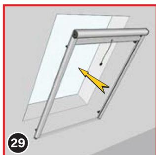
**ASTUCE** À partir de cette étape, il est recommandé de travailler à deux. Placez l'ensemble du store dans l'embrasure de la fenêtre de toit à l'endroit où il sera installé par la suite. Alignez le store de manière à ce que le joint brosse assure une étanchéité optimale tout autour
