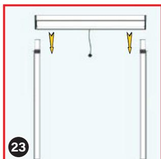
Assemblez le caisson du store et les rails de guidage latéraux en insérant les languettes des embouts (2) dans la rainure prévue à l'intérieur des rails de guidage.
