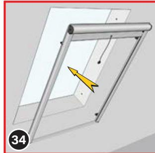
Prenez ensuite le store avec les axes de fixation (15) verrouillés et positionnez-le correctement. Les goupilles de maintien sont accrochées dans les douilles correspondantes.
