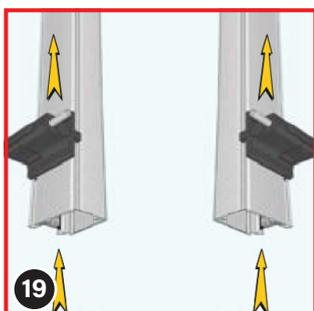
19 Placez les deux rails de guidage en position inversée. Insérez ensuite d'abord un axe de fixation (15) dans chaque rail de guidage par le bas, sur environ 20 cm. Si cela s'avère difficile, utilisez un marteau (en caoutchouc) pour vous aider.
