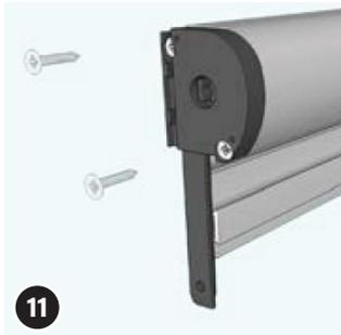
11 Insérez la tête tendue (2) sur le caisson et fixez-la avec deux vis 3,5x30.
