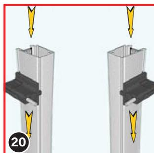
20 Insérez maintenant les autres axes de fixation (15) dans les rails de guidage par le haut, sur environ 20 cm. Alignez-les dès maintenant avec précision, car il sera difficile de modifier leur position par la suite une fois le joint brosse inséré.
