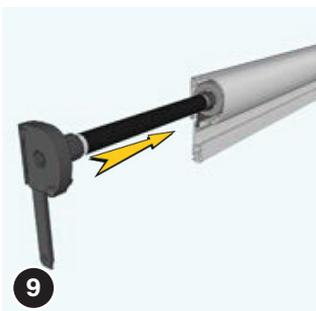
Insérez le ressort assemblé dans le caisson jusqu'à ce qu'il dépasse d'environ la largeur d'une main.
