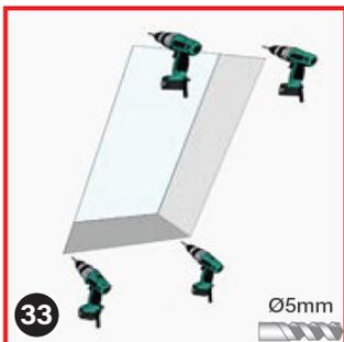
Retirez le cadre du store et percez les trous avec un foret de Ø 5 mm. Insérez ensuite les chevilles universelles fournies (il peut être nécessaire de vous procurer des chevilles spéciales pour cavités ou pour plaques de plâtre dans un magasin de bricolage).
