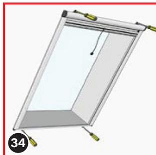
Replacez le cadre du store dans sa position et fixez-le à la pente du toit en le vissant à l'aide des vis 4x40 à travers les équerres de fixation (15).
