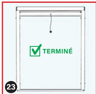
Le caisson supérieur du store, les rails de guidage latéraux et le profil de finition inférieur sont désormais assemblés pour former un cadre.
