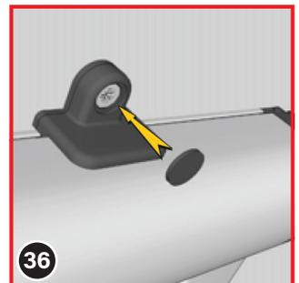
Pour finir et pour un aspect plus esthétique, placez les caches sur les équerres de fixation (13).
