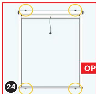
Insérez deux équerres de fixation (13) en haut dans le caisson du store et en bas dans le profil de finition. Pour les caissons de store larges, insérez également une équerre de fixation supplémentaire au milieu.
