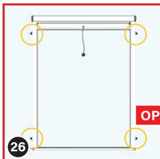
Insérez deux équerres de fixation (13) latéralement dans les rails de guidage, à environ 10 cm du haut et du bas. Pour des rails de guidage très longs, insérez également une équerre de fixation supplémentaire au milieu.
