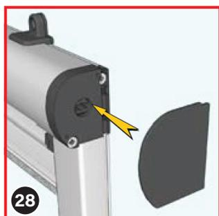
Après avoir enfoncé et positionné les équerres de fixation (13), fixez les capots latéraux (3) sur le caisson du store.
