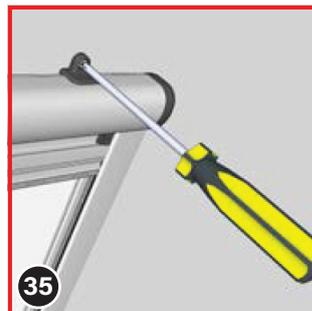
Sie können dies mit einem Vous pouvez le faire avec un tournevis ou une visseuse. Si vous utilisez une visseuse, nous vous recommandons de serrer les vis à une faible puissance afin de ne pas endommager les têtes des vis.
