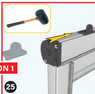
Utilisez un marteau en caoutchouc pour faciliter l'insertion des équerres de fixation (13). Elles doivent être enfoncées d'environ 10 cm de chaque côté.
