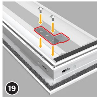
Schrauben Sie die Winkellaschen (27) oben und unten mit den Linsenkopfschrauben M3 x 5 (29) und dem 2,0 mm Sechskantschlüssel (14) fest. Entnehmen Sie die korrekte Position aus dem nebenstehenden Bild. Ziehen Sie die Schrauben noch nicht ganz fest, damit sich die Winkellaschen noch verschieben lassen.
