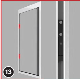
Im Befestigungsprofil gegenüber der Griffschiene befinden sich zwei Justierblöcke (16)/(17) - je ein Justierblock oben und unten. Damit kann die Schnurspannung reguliert werden.
