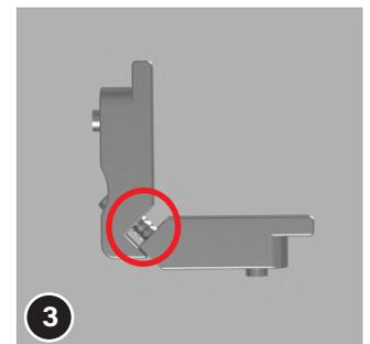
Stellen Sie sicher, dass die Schrauben der Eckwinkel (3) leicht aufgedreht sind, aber trotzdem beide Hälften zusammenhalten. Die Schrauben können mit dem mitgelieferten 3,0 mm Sechskantschlüssel (15) gelöst werden.
