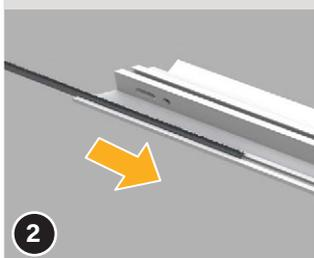
Schieben Sie die Bürste (19) in den Bürstenkanal der Montageprofilen (1) & (2) in den Abschnitten A, B, C & D. Trennen Sie überstehende Bürsten mit einer Schere ab.
