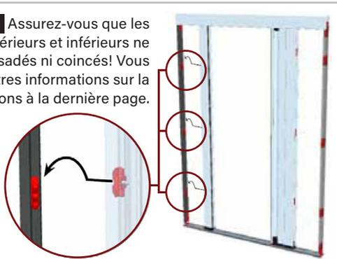
**Accrocher le profil de butée (5a) dans l'un des deux profils muraux (3)**
