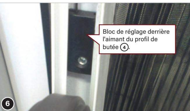
Bloc de réglage derrière l'aimant du profil de butée (4).
