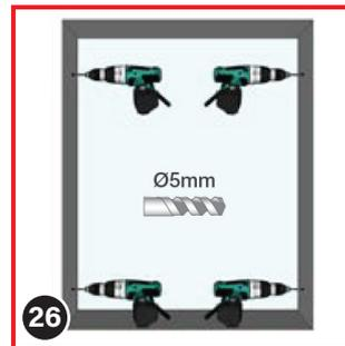
Percez maintenant les trous dans le mur à l'aide d'un foret Ø 5 mm et installez des chevilles (12) si nécessaire.
