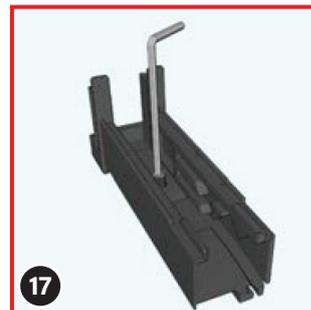
Vissez maintenant une vis sans tête ⑩ dans le trou des socles à l'aide de la clé hexagonale ⑨.
