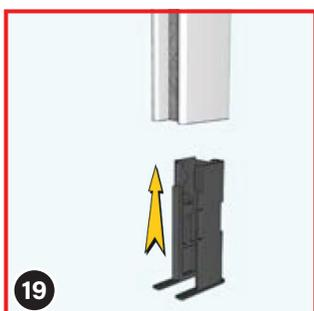
Insérez les socles ⑥ dans les rails de guidage latéraux.
