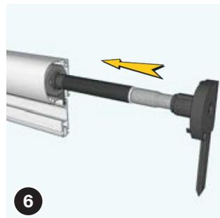
Insérez l'embout droit (2) assemblé, comme illustré, dans l'axe du filet dans le caisson du store (veillez aux encoches sur le palier / le frein de retour!). Maintenez l'axe du filet de l'autre côté pour éviter qu'il ne soit poussé hors du caisson.
