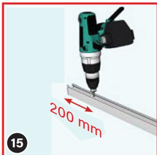
Percez deux trous de 4,5 mm de diamètre dans les rails de guidage. Percez-les à une distance d'environ 200 mm des extrémités du profil. Pour une longueur de rail supérieure à 1500 mm, percez un trou supplémentaire au centre.
