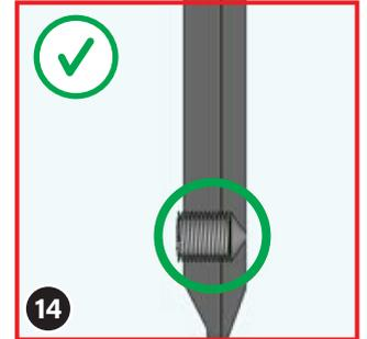
Vissez seulement jusqu'à ce que la pointe de la vis sans tête ⑩ soit affleurante avec l'autre côté de la languette de l'embout.
