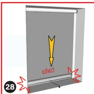
Abaissez votre moustiquaire installée jusqu'à ce que le verrouillage automatique s'enclenche des deux côtés avec un « clic ». **IMPORTANT** Pour un fonctionnement optimal lors de l'ouverture et de la fermeture, manipulez toujours la barre de préhension avec deux mains et une pression uniforme!
