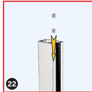
Glissez deux écrous carrés (13) dans la rainure située à l'arrière de chaque rail de guidage.
