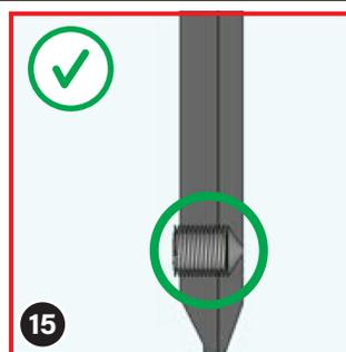
Vissez seulement jusqu'à ce que la pointe de la vis sans tête (10) soit affleurante avec l'autre côté de la languette de l'embout.
