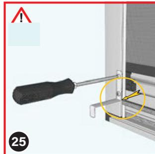
Fixez maintenant les équerres (3) sur le profil de fermeture (12) à l'aide des vis à tête bombée (12) et des écrous carrés (13) insérés précédemment.
