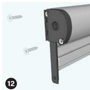
Fixez l'embout (2) tendu sur le caisson et vissez-le avec deux vis 3,5x30.
