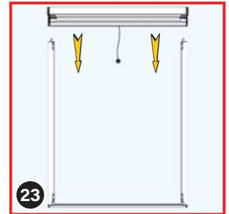
Assemblez le caisson du store et les rails de guidage latéraux en insérant les languettes des embouts (2) dans la rainure prévue à cet effet à l'intérieur des rails de guidage.
