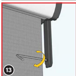
Les deux embouts (2) possèdent une languette avec un trou. Insérez maintenant une vis sans tête (10) dans ce trou depuis l'intérieur, à l'aide de la clé hexagonale (9) fournie.
