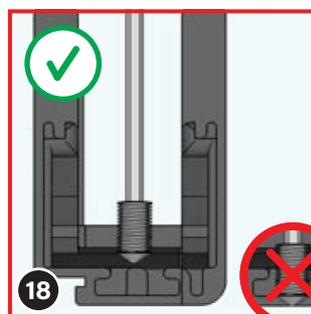
Vissez la vis sans tête (10) dans le socle uniquement jusqu'à la position indiquée sur l'image ci-dessus.
