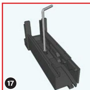
Vissez maintenant une vis sans tête (10) dans le trou des socles à l'aide de la clé hexagonale (9) fournie.
