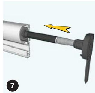
Insérez l'embout droit (2) assemblé, comme illustré, dans l'axe du filet dans le caisson du store (veillez aux encoches sur le palier / le frein de retour!). Maintenez l'axe du filet de l'autre côté pour éviter qu'il ne soit poussé hors du caisson.
