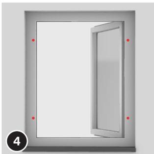
Markieren Sie am Fensterahmen die Bohrstellen für die Löcher, in welchen der Montagerahmen angeschraubt werden soll.
