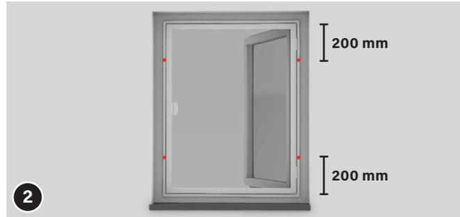
Markieren Sie frontal die Bohrstellen. Wir empfehlen für die Befestigung des Fensters zwei Bohrungen pro Rahmenseite. Die Bohrmarkierungen ca. 20 cm vom oberen und unteren Rand des Montagerahmens anzeichnen.
