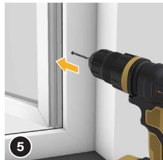
Bohren Sie die angezeichneten Löcher ggf. mit einem kleineren Bohrer, z. B. Ø 3 mm, vor.
