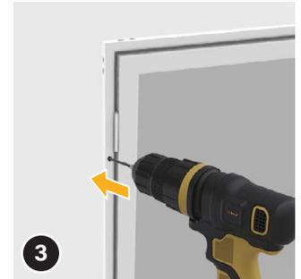
Bohren Sie die Löcher mit einem Ø 4 mm Metall-Bohrer. Bohren Sie komplett durch den Montagerahmen hindurch. Nehmen Sie dann wieder den Rahmen und halten Sie diesen an die Montageposition.
