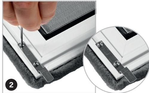
Befestigen Sie mit dem mitgelieferten Sechskantschlüssel ③ in jeder Ecke des Rahmens je eine Winkellasche ① mit zwei der beiliegenden Linsenkopfschrauben ②.
