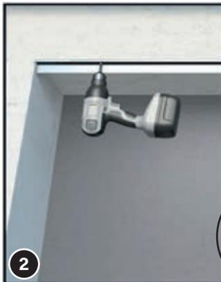
Percez 2 à 3 trous dans le rail supérieur et dans le linteau ou le plafond. Fixez le rail de guidage (1) avec les vis (17) et chevilles (18) fournies.
