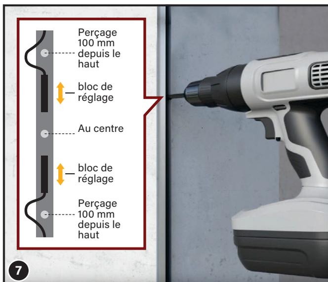
**ATTENTION** Ne pas percer à travers les blocs de réglage (pièces en plastique noir) et les cordons dans le rail de fixation (5) ! S'il y a déjà un aimant à cet endroit, retirez-le et fixez-le à la barre de poignée. Il ne faut pas percer à travers l'aimant !
