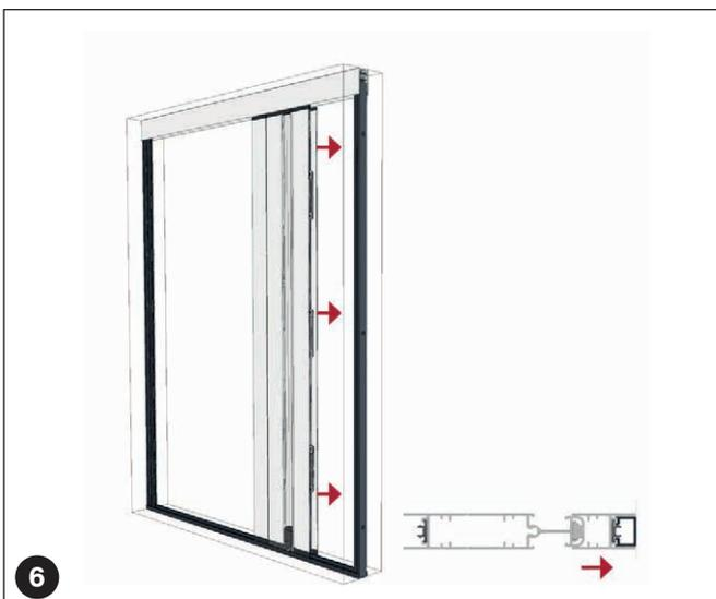
Das Gewebepaket (5) mit der Seite des Anschlagprofils (5b), auf der gewünschten Anschlagseite, gegen eines der Befestigungsprofile (3) schieben.
