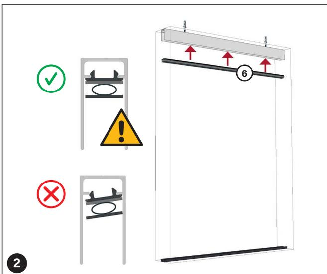
Das Ausgleichsprofil ⑥ in die obere Führungsschiene ① einführen. Dann mit sanftem Druck das am Ausgleichsprofil ⑥ befindliche PVC-Profil in die Nut der oberen Führungsschiene ① einklicken.
