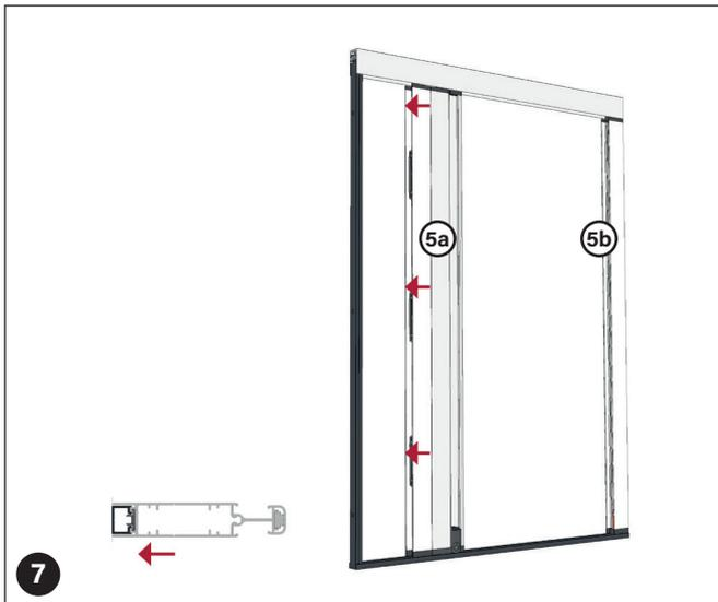
Das Kastenprofil mit Griffschiene (5a) in die Gegenrichtung verschieben und mit leichtem Druck auf ganzer Höhe im schon fixierten Befestigungsprofil (3) und dessen Halteklammern einklicken.
