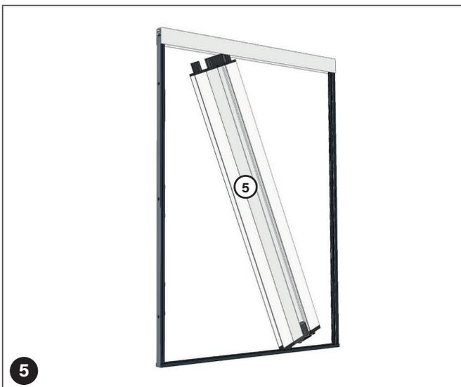
Das Gewebepaket (5) zwischen die Führungsschienen (1) und (2) stellen.
