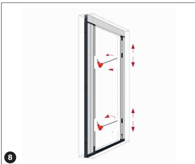
Bei einer eventuellen Regulierung aller Schnüre, bitte an den Schnurhaltern des Anschlagprofils (5b) oben und unten so arbeiten, so dass alle Schnüre gespannt sind.
