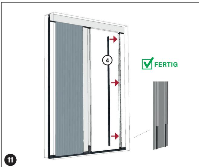
Abschließend das PVC-Profil (4) im Anschlagprofil (5b) einklicken.
