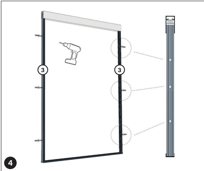
Die Befestigungsprofile (3) in den Führungsschienen ((1) und (2)) positionieren und auf den beiden Seiten der Laibung mit Schrauben (und ggf. Dübel) fixieren.
