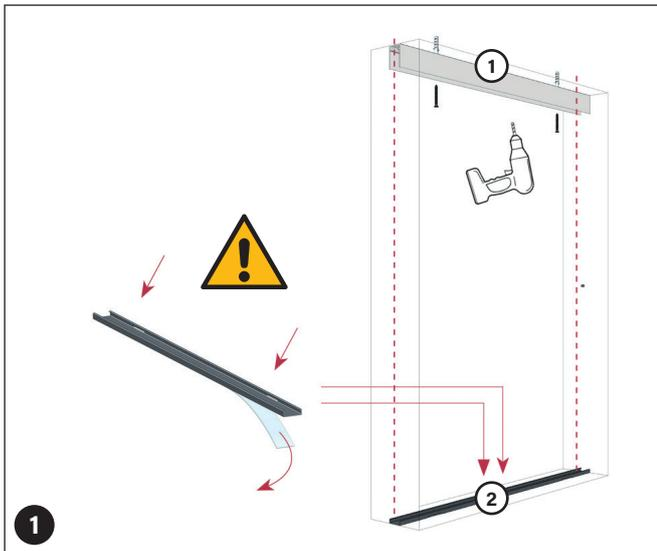
Die obere Führungsschiene ① mit Schrauben (und ggf. Dübeln) in Decke/Sturz befestigen (Schrauben-Bit siehe Zubehörpäckchen).
