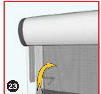
Serrez ensuite les vis sans tête (10) des languettes des embouts à l'aide de la clé hexagonale (9), de manière à ce que la pointe des vis sans tête appuie légèrement sur les rails de guidage. Vous sentirez alors la résistance du métal.
