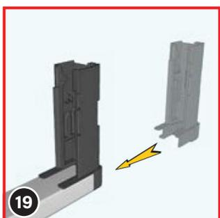
Insérez ensuite les socles (6) latéralement sur le profil de fermeture. Si cela est un peu difficile, vous pouvez utiliser un marteau (en caoutchouc) avec précaution (!) pour faciliter l'opération.
