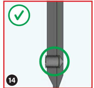
Vissez seulement jusqu'à ce que la pointe de la vis sans tête (10) soit affleurante avec l'autre côté de la languette de l'embout.
