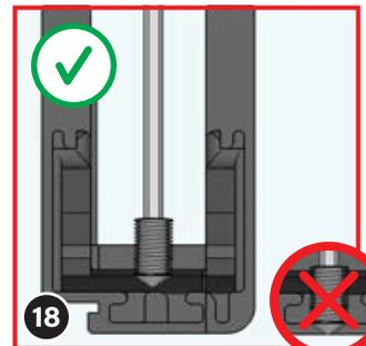
Vissez la vis sans tête (10) dans le socle uniquement jusqu'à la position indiquée sur l'image ci-dessus.
