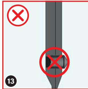
Ne vissez en aucun cas la vis sans tête (10) avec la pointe au point qu'elle dépasse de l'autre côté de la languette!
