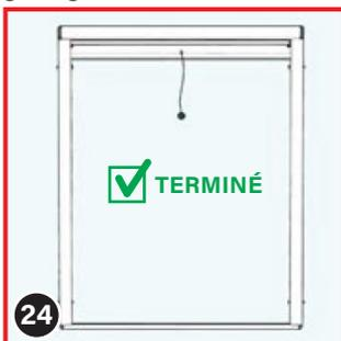
Le caisson supérieur du store, les rails de guidage latéraux et le profil de fermeture inférieur sont désormais assemblés pour former un cadre.
