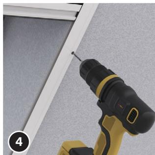
Marquez les emplacements des trous à percer sur la pente du toit et percez-les.
