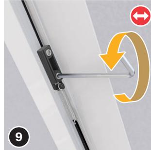
Desserrez le bloc de réglage supérieur (21) ou (22) à l'aide de la clé hexagonale de 2,0 mm (11).
