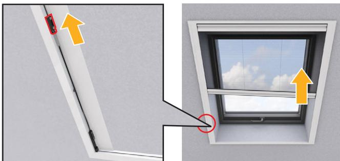
**CONSEIL** En cas de rail de préhension incliné, les blocs de réglage supérieurs ajustent le rail sur le côté opposé. Par exemple, si le rail de préhension s'affaisse à droite, déplacez le bloc de réglage gauche vers le haut.
