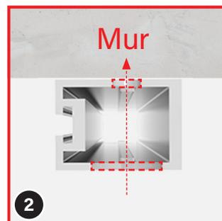
Prenez un foret à métal de  $\varnothing$  10 mm et agrandissez le trou de perçage du côté visible à 10 mm.
