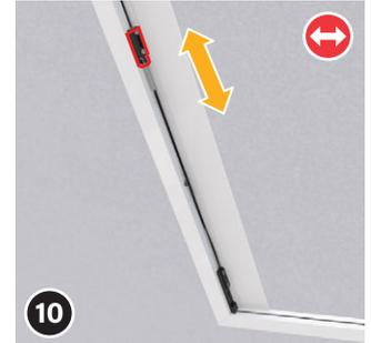
Déplacez le bloc de réglage vers le haut ou vers le bas. Refixez le bloc de réglage et observez la position du rail de préhension ainsi que la tension du filet. Répétez l'opération des deux côtés jusqu'à ce que le rail de préhension soit droit, qu'il reste en place tout seul et que le store plissé s'ouvre et se ferme sans problème.
