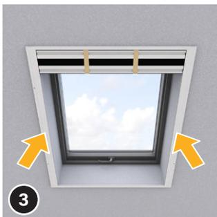
Placez maintenant le cadre sur l'ouverture de la fenêtre de toit et alignez-le dans la position souhaitée.
