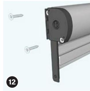
Das gespannte Kopfteil ② am Kasten aufstecken und mit zwei Schrauben 3,5x30 anschrauben. **ACHTUNG** Schrauben gerade einschrauben und nicht überdrehen, da sonst das Netz beschädigt werden kann!
