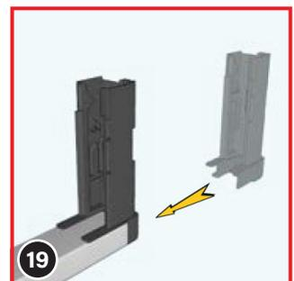
Stecken Sie die Sockel ⑥ anschließend seitlich auf das Abschlussprofil auf. Falls dies etwas schwer geht, können Sie vorsichtig (!) mit einem (Gummi-)Hammer nachhelfen.
