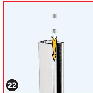
Schieben Sie jeweils zwei Vierkantmutter (13) in die Nut auf der Rückseite beider Führungsschienen.
