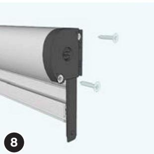
Schrauben Sie das rechte Kopfteil dann mit zwei Schrauben 3,5x30 am Rollokasten an.
