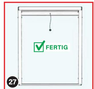
Nun sind der obere Rollokasten, die seitlichen Führungsschienen und das untere Abschlussprofil zu einem Rahmen miteinander verbunden.
