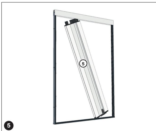
Placez le paquet de tissu ⑤ entre les rails de guidage supérieur ① et inférieur ②.
