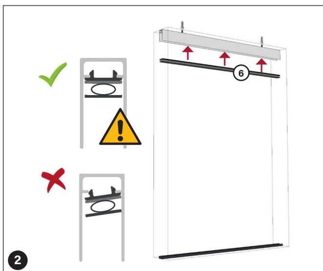
Insérez le profilé de compensation (6) dans le rail de guidage supérieur (1). Ensuite, appuyez légèrement pour clipser le profilé en PVC fixé au profilé de compensation (6) dans la rainure du rail de guidage supérieur (1).
