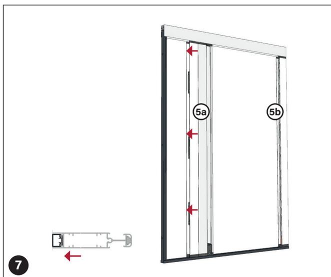
Faites glisser le profil de caisson avec la barre de poignée (5a) dans la direction opposée. Exercez ensuite une légère pression sur toute la hauteur pour le clipser dans le profil de fixation (3) déjà en place et dans ses clips noirs de maintien.
