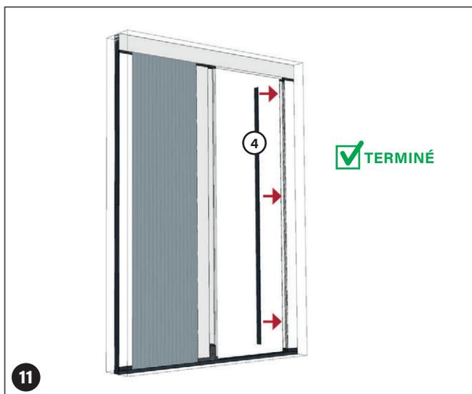
Enfin, clipsez le profil en PVC (4) dans le profil de butée (5b).
