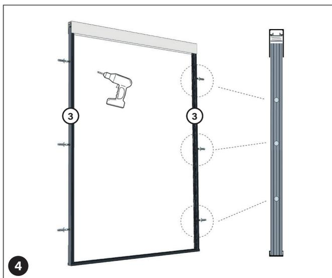
Positionnez les profils de fixation ③ dans les rails de guidage supérieur ① et inférieur ②, puis fixez-les des deux côtés de l'embrasure avec des vis et, si nécessaire, des chevilles.
