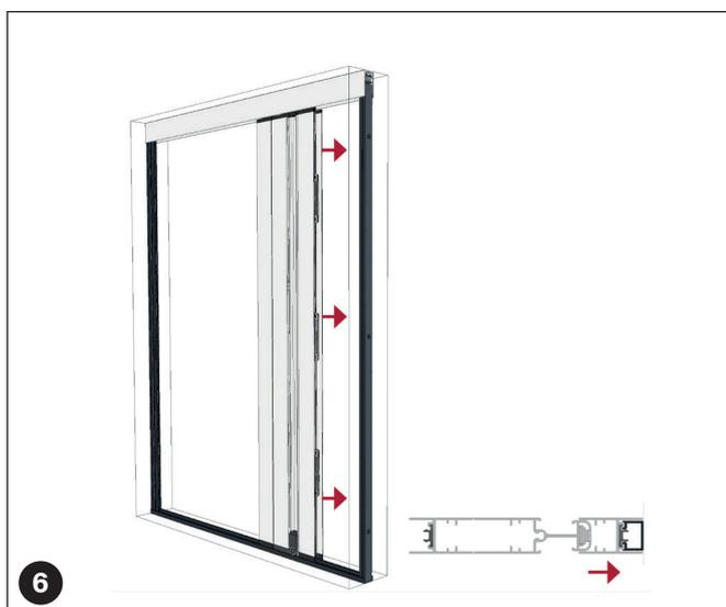
Faites glisser le paquet de tissu ⑤, avec le côté du profil de butée ⑤b, sur le profil de fixation ③ situé du côté souhaité pour le butée.
