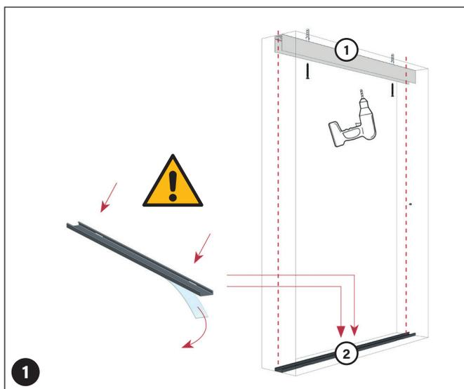
Fixez le rail de guidage supérieur (1) au plafond ou à l'embrasure avec des vis (et éventuellement des chevilles) en utilisant l'embout de vis approprié fourni dans le kit d'accessoires.
