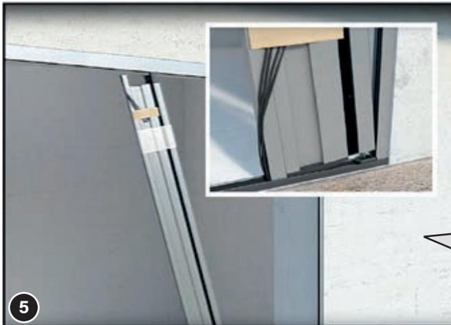
Fixez maintenant le coffre plissé dans l'aimant du rail de fixation (5). Placez simplement le coffre plissé entre le rail de guidage (1) et le rail inférieur (2). L'aimant situé à l'arrière du coffre plissé s'enclenchera dans l'aimant du profil mural.
