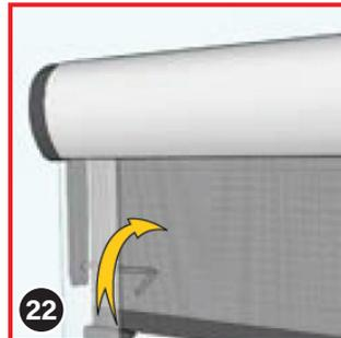
Drehen Sie dann mit dem Sechskantschlüssel (9) die Madenschrauben (10) der Zungen der Kopfteile so fest, dass sich die Spitze der Madenschrauben ganz leicht in die Führungsschienen drückt. Man spürt dabei den Widerstand des Metalls.
