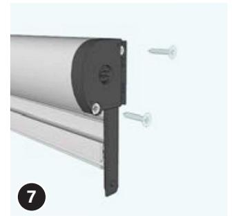
Schrauben Sie das rechte Kopfteil dann mit zwei Schrauben 3,5x30 (14) am Rollokasten an. **ACHTUNG Schrauben gerade einschrauben und nicht überdrehen, da sonst das Netz beschädigt werden kann!**
