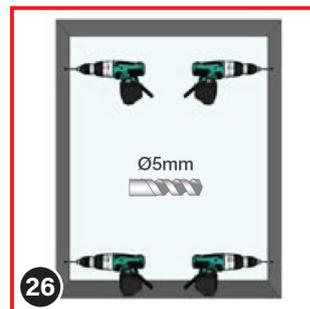
Bohren Sie nun mit einem Bohrer Ø 5 mm die Löcher in die Wand und installieren Sie nach Bedarf Dübel (12).
