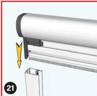
Fügen Sie den Rollokasten und die seitlichen Führungsschienen zusammen, indem Sie die Zungen der Kopfteile (2) in die vorgesehene Nut innerhalb der Führungsschienen einstecken.
