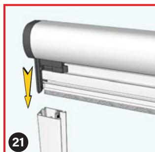
21 Assemblez le caisson du store et les rails de guidage latéraux en insérant les languettes des têtes (2) dans la rainure prévue à cet effet à l'intérieur des rails de guidage.
