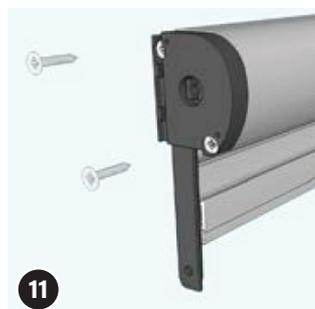
Insérez la tête tendue (2) sur le caisson et fixez-la avec deux vis 3,5x30.
