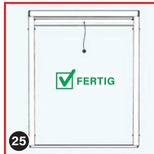
Nun sind der obere Rollokasten, die seitlichen Führungsschienen und das untere Abschlussprofil zu einem Rahmen miteinander verbunden.
