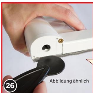
Jetzt an einer Ecke des Rollos beginnen die Bürstendichtung mithilfe des Eindrückerwerkzeugs (13) in die umlaufende Nut einzudrücken. Beim ersten Haltestift (15) stoppen, die Bürste mit einer Schere abschneiden
