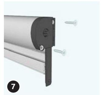
Schrauben Sie das rechte Kopfteil dann mit zwei Schrauben 3,5x30 am Rollokasten an.
