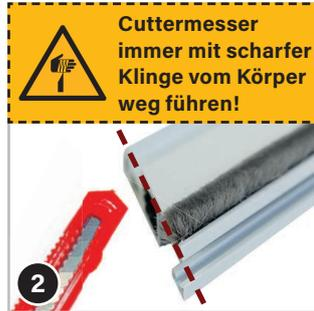
Dichtungsbürste (8) entlang der Profilkanten mit einem scharfem Cuttermesser gerade abschneiden.
