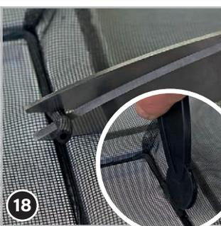
Gummikeder 9 am Ende ca. 10 mm länger lassen; dann mit Messer oder Schere abschneiden. Anschließend das Ende in Nut stecken und Wulst mit Kedereindrücker 6 eindrücken.
