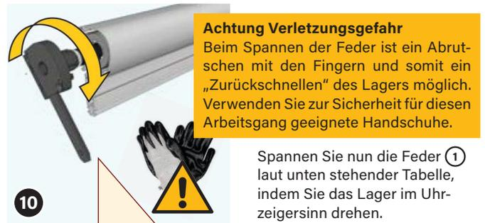
Spannen Sie nun die Feder (1) laut unten stehender Tabelle, indem Sie das Lager im Uhrzeigersinn drehen.
