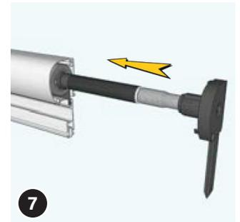
Insérez l'embout droit (2) assemblé, comme illustré, dans l'axe du filet dans le caisson du store (veillez aux encoches sur le palier / le frein de retour!). Maintenez l'axe du filet de l'autre côté pour éviter qu'il ne soit poussé hors du caisson.
