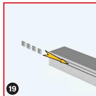
Insérez quatre écrous carrés ⑬ dans la rainure située à l'arrière du profil de fermeture.
