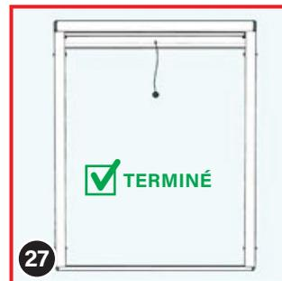
Le caisson supérieur, les rails de guidage latéraux et le profil de fermeture inférieur sont désormais assemblés pour former un cadre.
