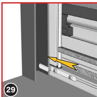
Positionnez ensuite les équerres sur le caisson du store et les rails de guidage de manière à ce qu'elles s'emboîtent dans les rails du store. Serrez ensuite les vis fermement.
