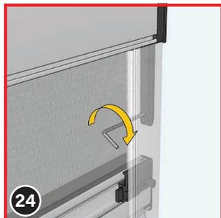
Serrez ensuite les vis sans tête (10) des languettes des embouts à l'aide de la clé hexagonale (9), de manière à ce que la pointe des vis sans tête appuie légèrement sur les rails de guidage. Vous sentirez alors la résistance du métal.
