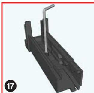
Vissez maintenant une vis sans tête ⑩ dans le trou des socles à l'aide de la clé hexagonale ⑨ fournie.
