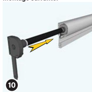
Insérez le ressort assemblé dans le caisson jusqu'à ce qu'il dépasse encore d'environ la largeur d'une main.
