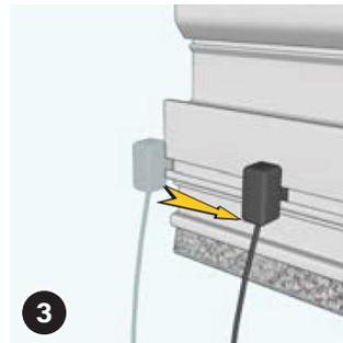
Si souhaité: Si vous souhaitez utiliser le cordon de traction (8), insérez-le maintenant dans la rainure étroite. Celle-ci se trouve également du côté de la large rainure de préhension de la barre de préhension.
