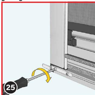
Fixez maintenant les équerres (3) sur le profil de fermeture à l'aide des vis à tête bombée (12) et des écrous carrés (13) insérés précédemment.
