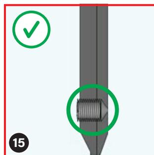
Vissez seulement jusqu'à ce que la pointe de la vis sans tête ⑩ soit affleurante avec l'autre côté de la languette de l'embout.
