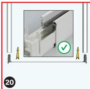
Insérez le profil de fermeture avec les socles (6) fixés dans les rails de guidage latéraux.
