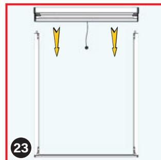
Assemblez le caisson du store et les rails de guidage latéraux en insérant les languettes des embouts (2) dans la rainure prévue à cet effet à l'intérieur des rails de guidage.
