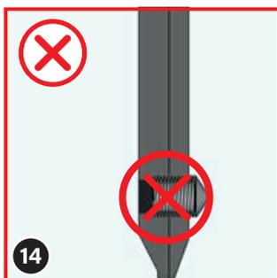
Ne vissez en aucun cas la vis sans tête ⑩ avec la pointe au point qu'elle dépasse de l'autre côté de la languette!
