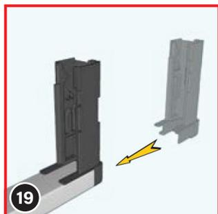
Insérez ensuite les socles (6) sur les côtés du profil de fermeture. Si cela est un peu difficile, vous pouvez utiliser un marteau (en caoutchouc) avec précaution (!).
