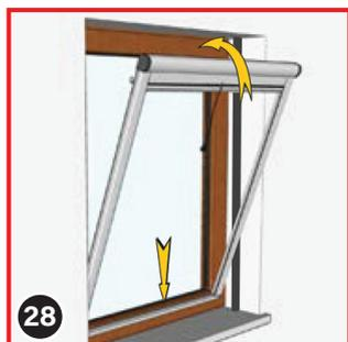
Soulevez le store jusqu'à la position prévue dans le cadre de la fenêtre. Laissez le profil de fermeture reposer sur le rebord de la fenêtre.
