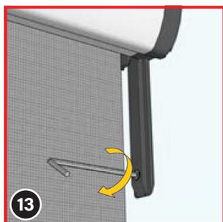
Les deux embouts ② possèdent une languette avec un trou. Insérez maintenant une vis sans tête ⑩ dans ce trou depuis l'intérieur, à l'aide de la clé hexagonale ⑨ fournie.
